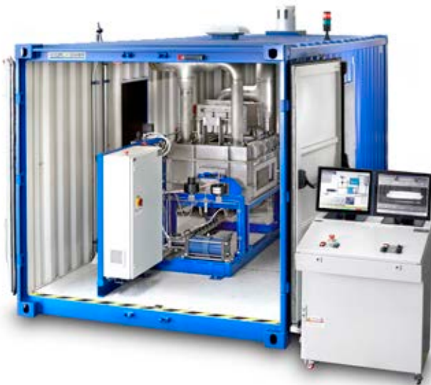
Banco per il collaudo con azoto della raccordatura Bench for nitrogen pressure test
